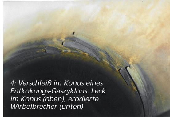
4: Verschleiß im Konus eines Entkokungs-Gaszyklons. Leck im Konus (oben), erodierte Wirbelbrecher (unten)
